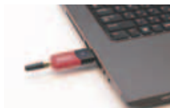
Bluetooth-USBアダプタ Parani-UD100 最大通信距離約30mに能力アップする外部アンテナ。パソコン側のBluetoothアンテナ(弊社推奨品)最大通信距離約30m(目安)
